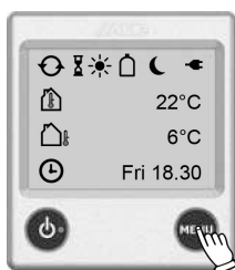
Fig. 143 : Unité de commande en position de repos
