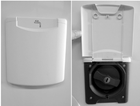
Fig. 91 : Manchon de remplissage d'eau fraîche
