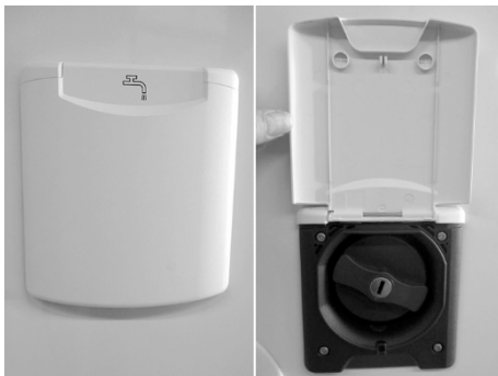
Fig. 21 : Manchon de remplissage d'eau fraîche
