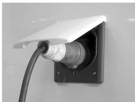
Fig. 57 : Branchement électrique sur le secteur
