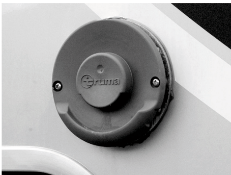
Fig. 78 : Conduit d'évacuation des gaz brûlés (sur la paroi)
