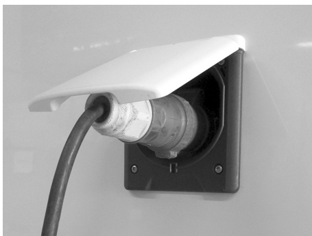
Fig. 2 : Branchement électrique sur le secteur
