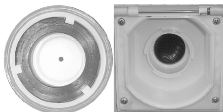
Fig. 96 : Bouchon à visser (à gauche) et manchon de remplissage d'eau fraîche (à droite)
