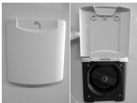
Fig. 95 : Manchon de remplissage d'eau fraîche
