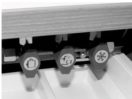
Fig. 69: Vannes d'arrêt rapides
