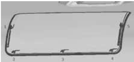
Fig. 31: Vue intérieure de la baie ouvrante galbée à cinq poignées de verrouillage
