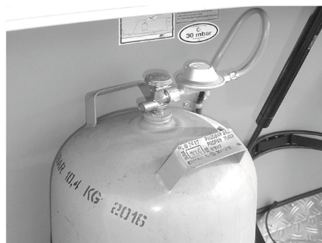
Bild 64: Gasolflaska med lågtrycksregulator och lågtrycksslang
