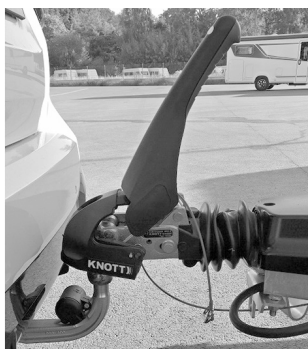
Fig. 13: Kuglekobling åben, stabilisering deaktiveret
