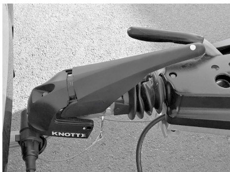
Fig. 10: Kuglekobling lukket, stabilisering aktiveret
