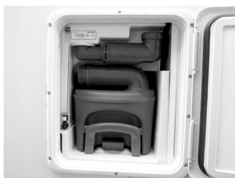
Fig. 64: Toilettank med påfyldningsstuds til skyllevand
