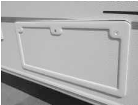
Fig. 34: Opholdsafdelingen, opbevaringsrum udvendig
