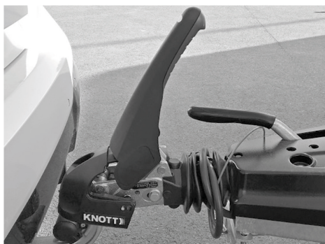
Fig. 9: Kuglekobling lukket, stabilisering deaktiveret
