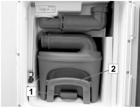
Fig. 158 : Cassette WC dans le puisard d'élimination
