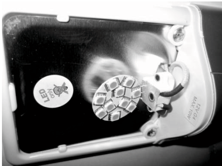
Fig. 177: Remplacement de l'ampoule LED
