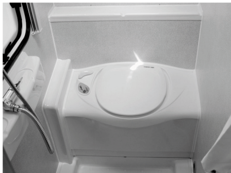
Fig. 63: Toilettes chimiques à cassette
